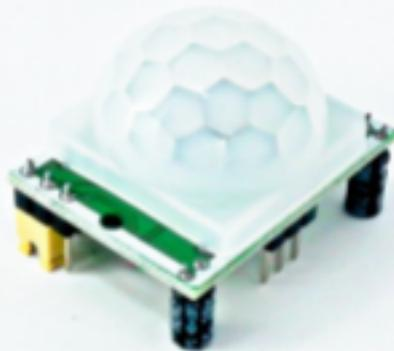
Die Funktionsweise unseres PIR-Bewegungsmeldemoduls auf Platine mit Schaltkontakt ist schnell erklärt. Es handelt sich um einen pyroelektrischer Sensors welcher Infrarotstrahlung wahrnehmen kann. Ähnliche Sensoren sind Beispielsweise in kontaklosen Infrarotthermometern verbaut. Über dem Modul ist eine kleine PlastikspHERE angebracht, welche die vom Sensor aufgenommene Infrarotstrahlung streut. Dadurch wird der Bereich in dem Bewegung erkannt wird vergrößert, bzw. gelenkt.
